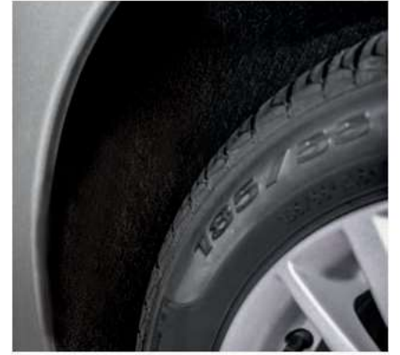
أعطية عجلات ناعمة لعزل صوتي أفضل: من أجل "امتصاص" الضوضاء التي تنتجها الرمال والحصى
