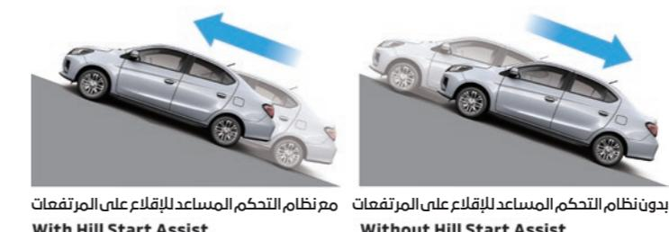
نظام التحكم المساعد للإقلاع على المرتفعات (HSA) يقوم نظام التحكم المساعد للإقلاع على المرتفعات بتسهيل الإقلاع على المنحدرات الحادة بمنع السيارة من الرجوع للخلف. عندما يتم رصد انحدار في الطريق، يحافظ النظام أتوماتيكياً على قوة الفرملة حتى يتم التفريغ على دواسة الوقود.
