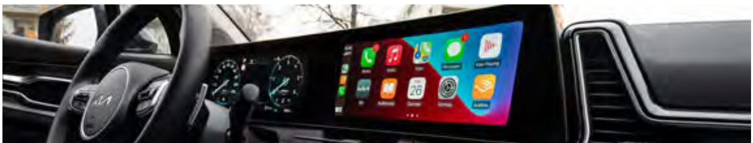
لوحة عدادات ديجيتال كاملة مقاس ١٢,٣ بوصة وشاشة متجنبة تعمل باللمس مقاس ١٢,٣ بوصة للمعلومات والترفيه 12.3 Inch Full Digital Cluster & 12.3 inch Touch Infotainment Curved Screen
